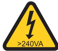
危険なエネルギーが存在します。危険なエネルギーを持つ電圧は、金属とショートすると加熱が生じる場合があり、金属が飛び散ったり、火傷したりする結果となる場合があります。(L005)
