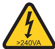
危険なエネルギーが存在します。危険なエネルギーを持つ電圧は、金属とショートすると加熱が生じる場合があり、金属が飛び散ったり、火傷したりする結果となる場合があります。(L005)
